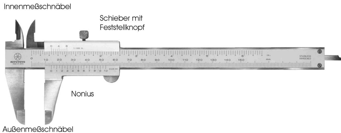
Abbildung 1.1: Messschieber zur Bestimmung von Längen; Messwert hier: (14,30 \pm 0,05) mm.
