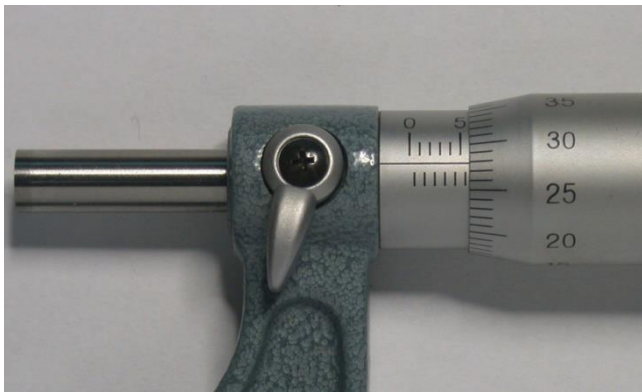
Abbildung 1.8: Bügelmessschraube zeigt d = 5,78 \text{ mm} .
