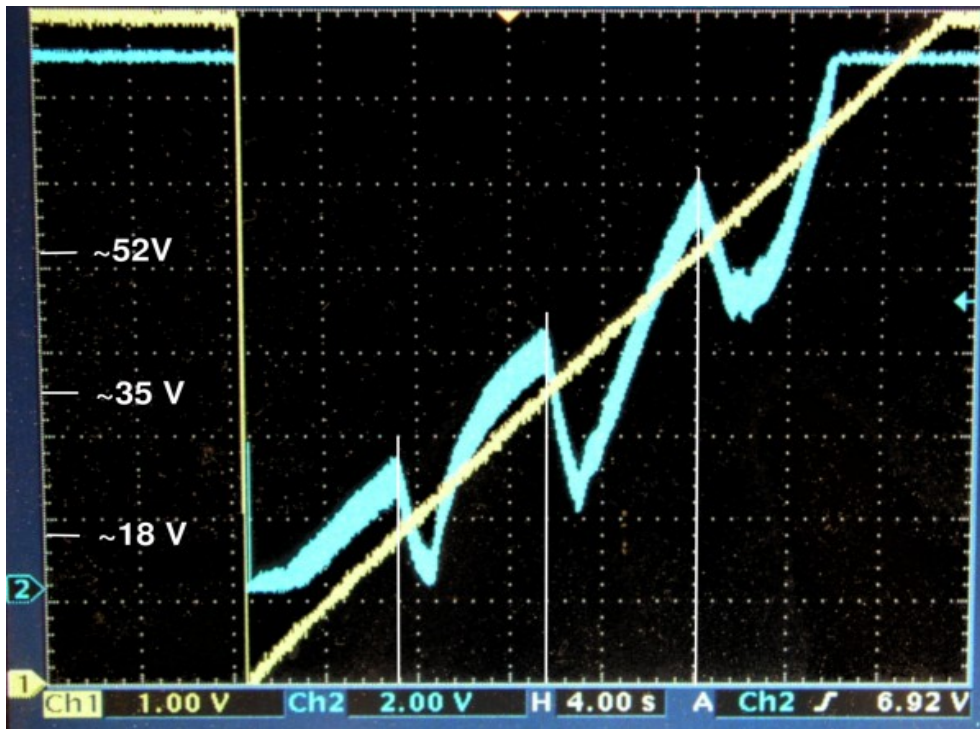
Abb. 2: Beschleunigungsspannung und Anodenstrom auf dem Oszilloskop
