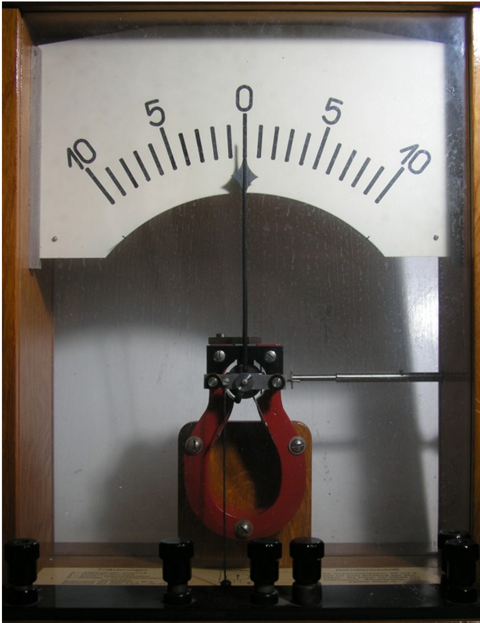
Abb. 1: Drehspulmessgerät mit gut einseharem Messwerk
