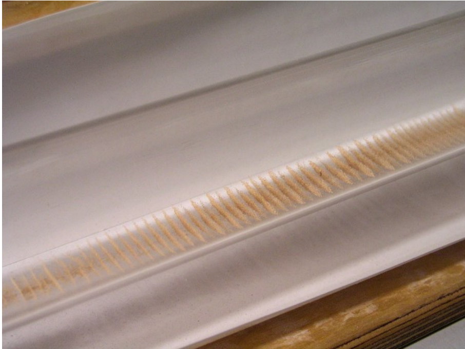
Abb. 2: Intensitätsmaximum bestehend aus ca. 50 Streifen ( \nu \approx 200 \text{ Hz} )
