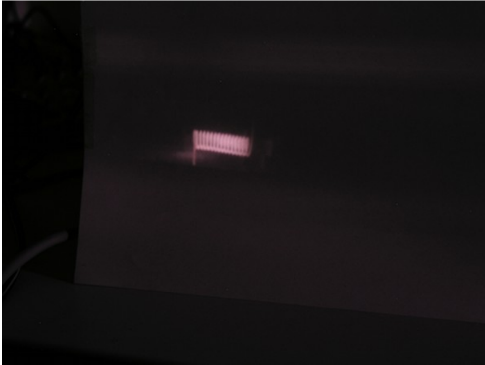
Abb. 1: Abbildung des Glühfadens einer Halogenlampe durch ein Pinhole
