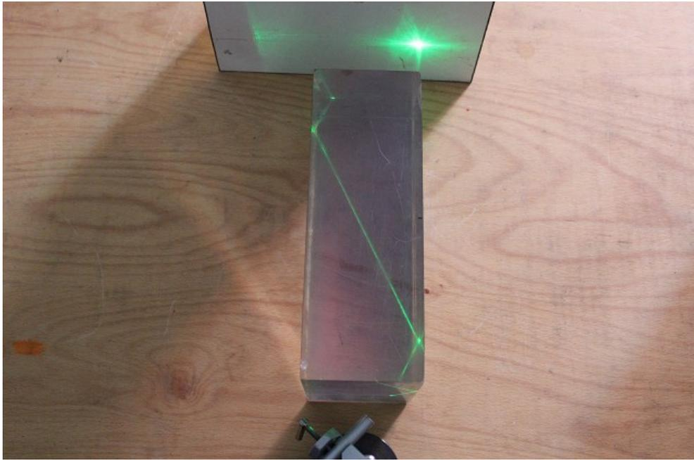
Abb. 1: Verlauf eines totalreflektierten Laserstrahls in einem Poliamydblock.
