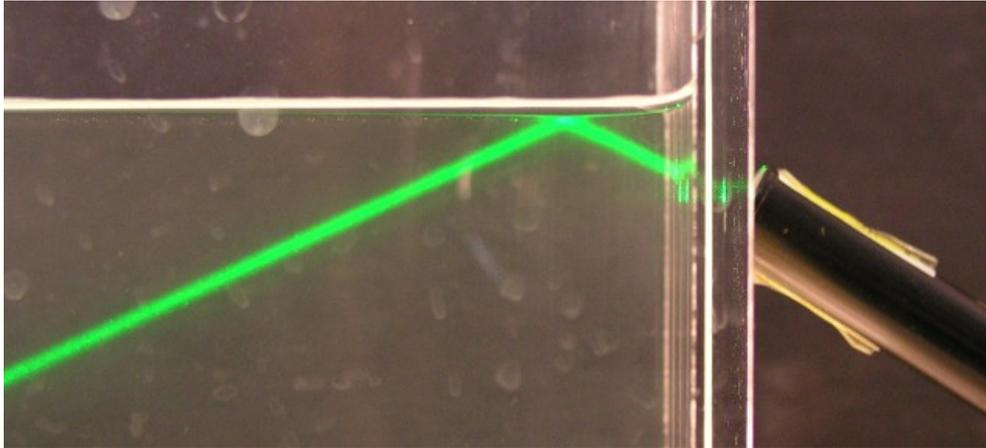
Abb. 2: Auch aus dem Wasser kann der Strahl bei flachen Winkeln nicht austreten.
