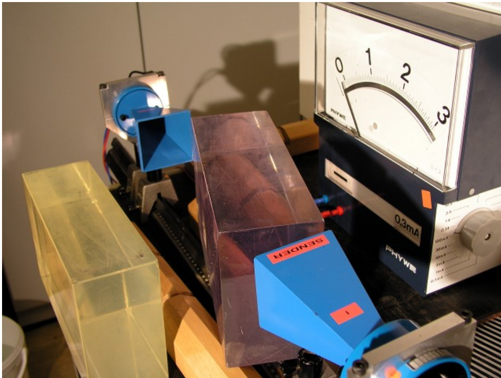
Abb. 2: Das Signal kommt nicht am Sender an, Totalreflexion am Übergang Epoxidharz-Luft
