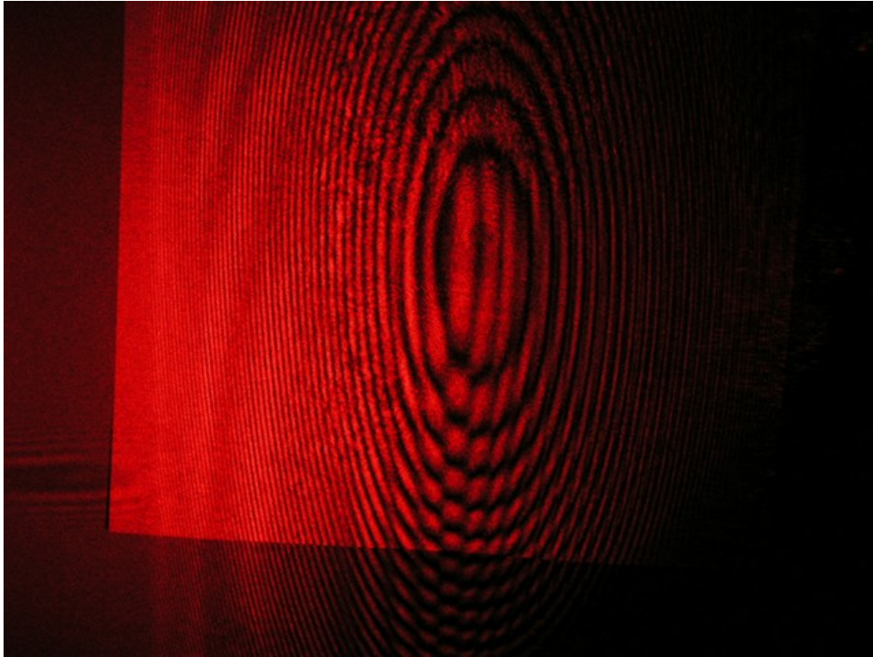
Abb. 1: Interferenzmuster eines Michelson Interferometers durch eine Feuerzeugflamme gestört.
