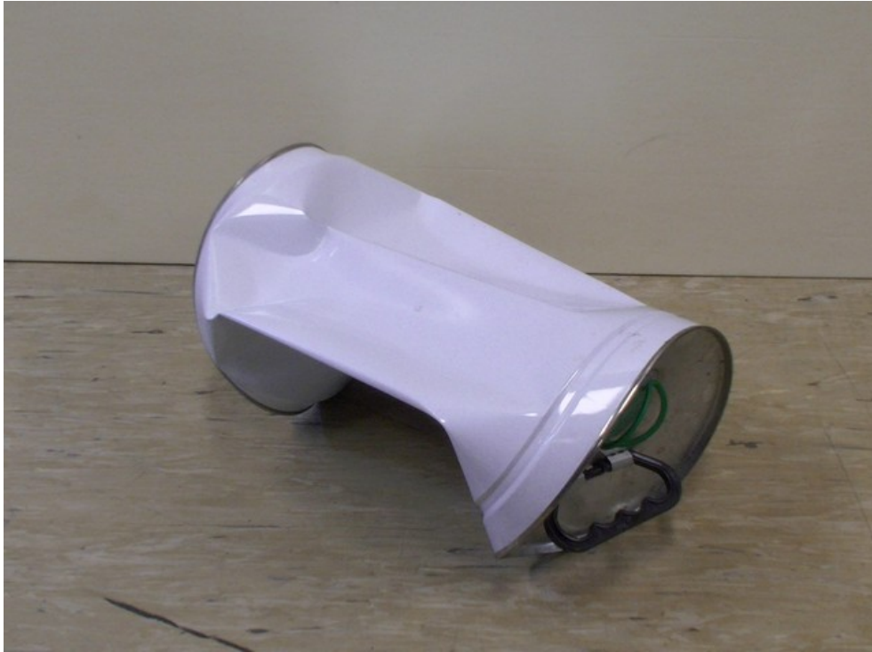
Abb. 2: Blechdose, vom Luftdruck zerstört.
