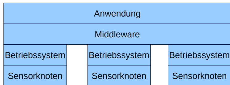
Abbildung 3.2: Die Softwareschichten in einem Sensornetzwerk (nach [RKJK03])
