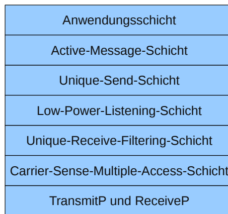
Abbildung 3.7: Der in dieser Arbeit verwendete energiereffiziente Funk-Netzwerkstapel für TinyOS
