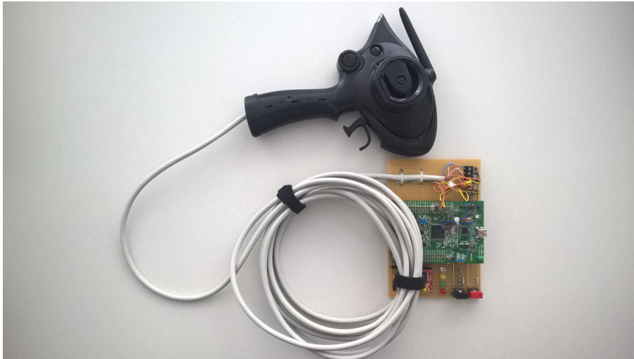
Abbildung 5.6.: CarControl: Entwicklungsboard mit befestigter Fernbedienung.
