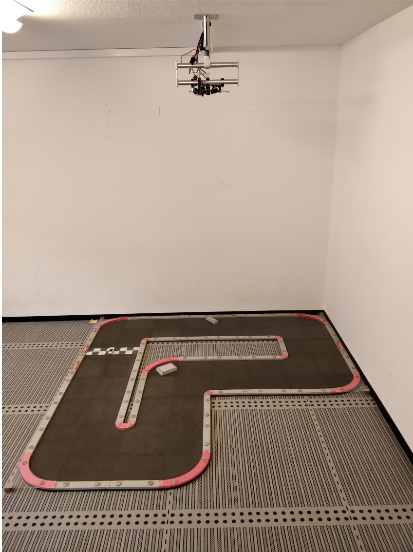
Abbildung 2.1.: Abbildung des Systems mit Rennstrecke, Fahrzeug und angebrachter Kamera
