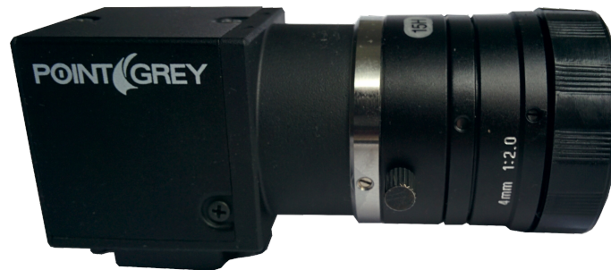
Abbildung 5.5.: Kamerasystem bestehend aus Kamera, Weitwinkelobjektiv und Infrarotfilter.
