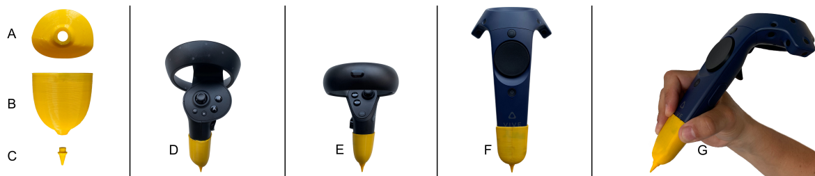
Abbildung 5.8: Der 3D gedruckte Stiftaufsatz (A, B, C) auf dem HP Reverb G2 (D), dem Oculus Rift S (E) und dem HTC Vive Pro Controller (F, G) [43]
