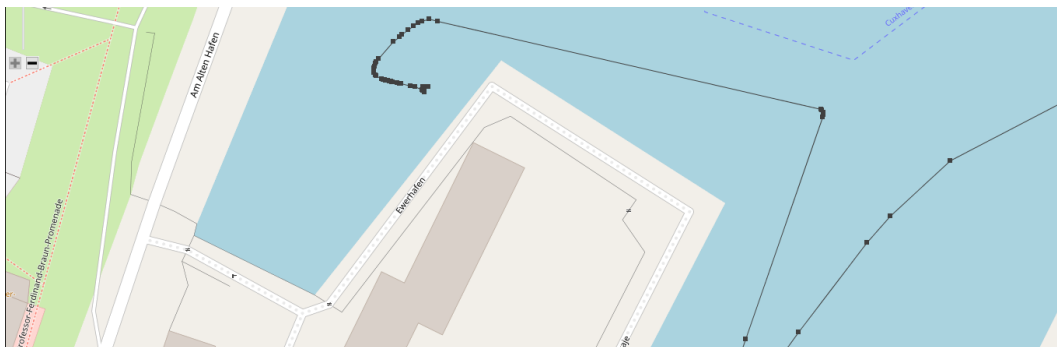
Abbildung 7-9: Durch Gaussian-Kernel-Filter geglättete AIS-Daten
