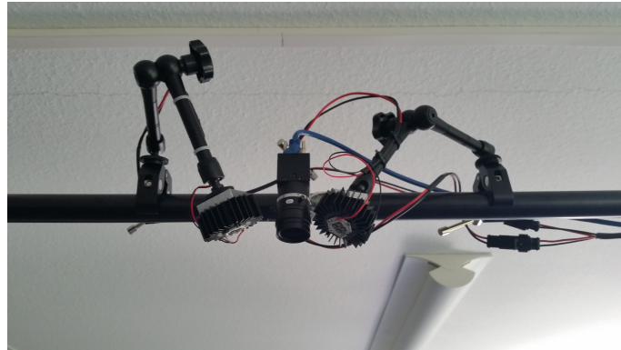
Abbildung 7.8: Kamera und Verbesserte Beleuchtungseinheit mit zwei Infrarotlampen.
