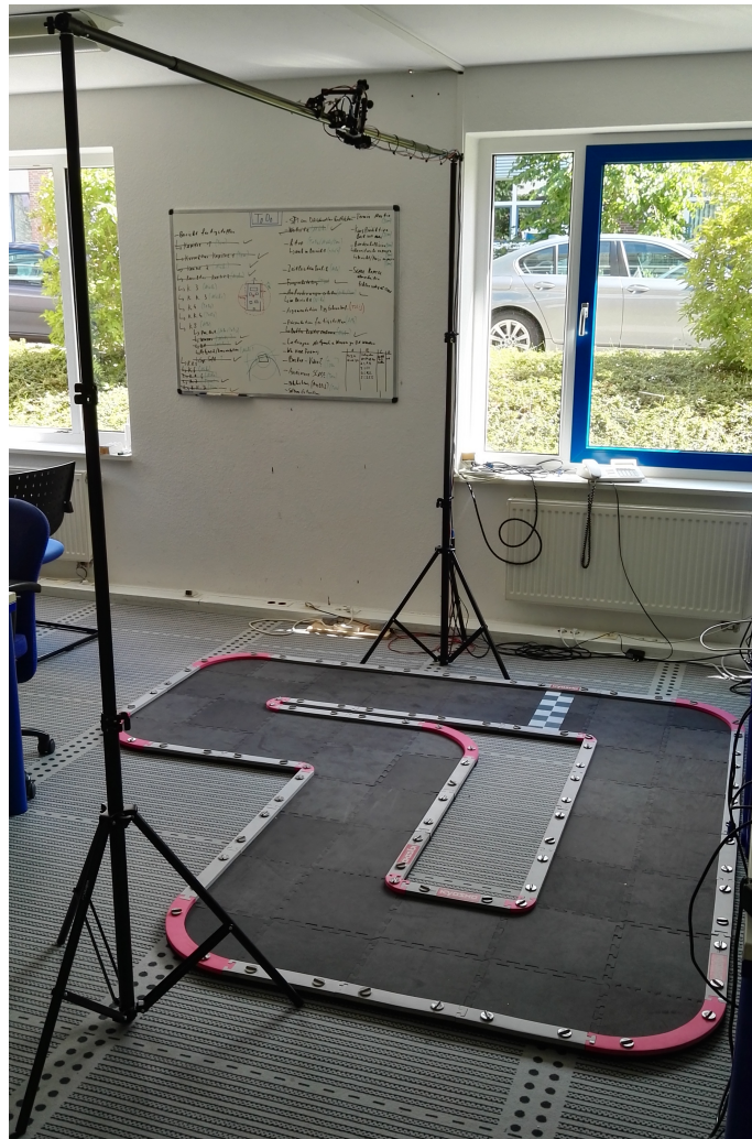
Abbildung 7.4: Aufbau der Hardwarekomponenten der Subsysteme Positionsbestimmung und Rennstrecke.
