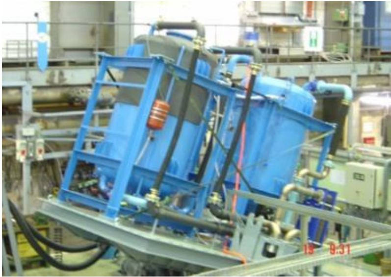
Abbildung 7: 140 kW Absorptionskälteanlage auf einem Prüfstand zum Test der Seetauglichkeit. Quelle: Wild 2012
