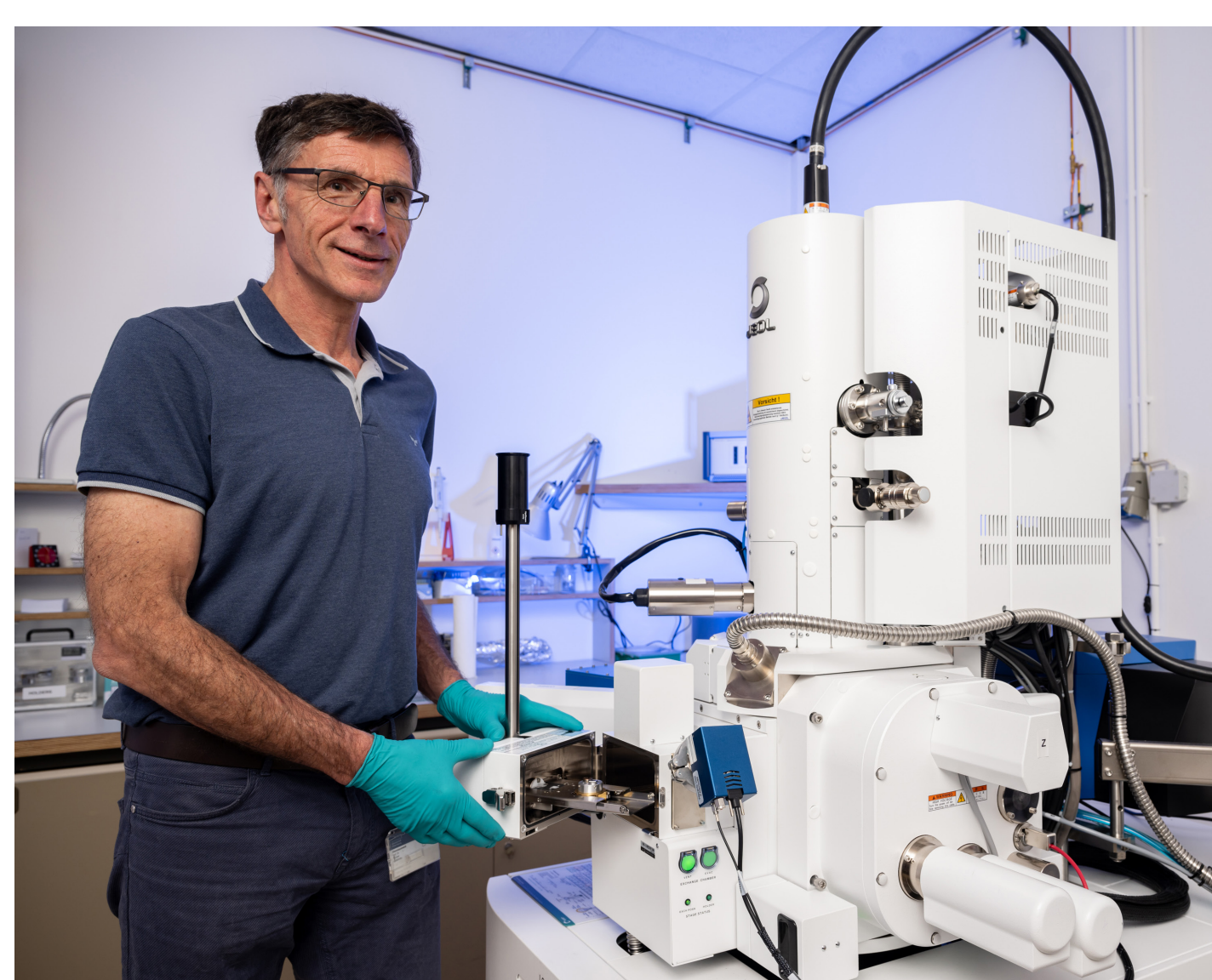
Jeol (SEM IT800) Rasterelektronenmikroskop Beschleunigungsspannung: 5-30 kV Vergrößerung: 60x - 2.000.000x Bildpunkt: 0,5-5 nm 6 Detektoren Kathodolumineszenzmikroskopie zur Analyse optischer und elektronischer Eigenschaften von Materialien
