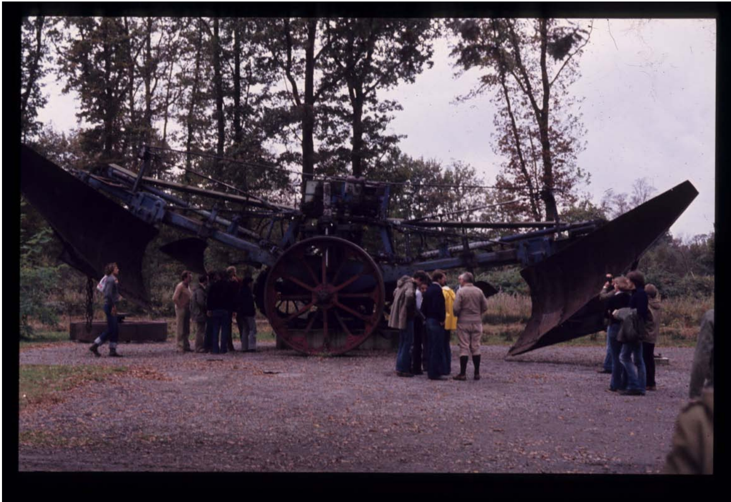
Dampfplug mit Pflugtiefen bis 2,20 m (ab 1958)
