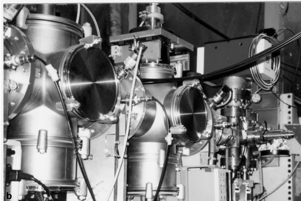
Abb. 3-3 XANES Meßzelle: schematisch (a), Foto (b)
