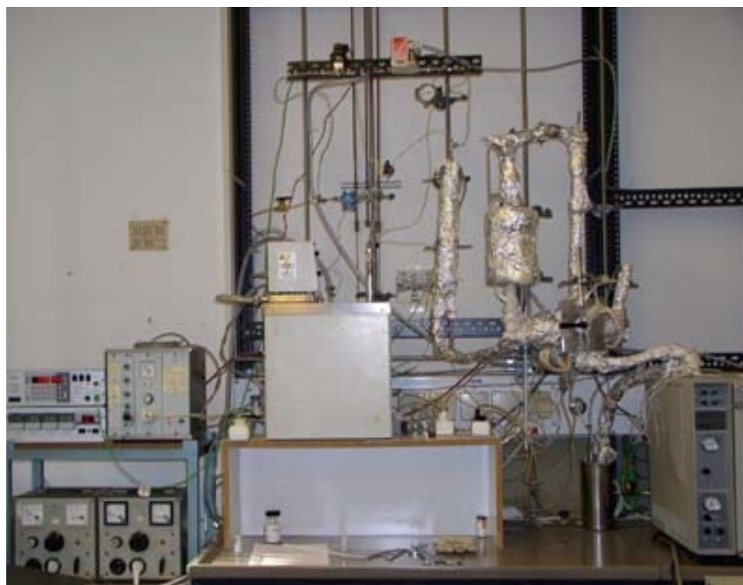
Abbildung 3.3: Foto der MBOH-Testanlage.
