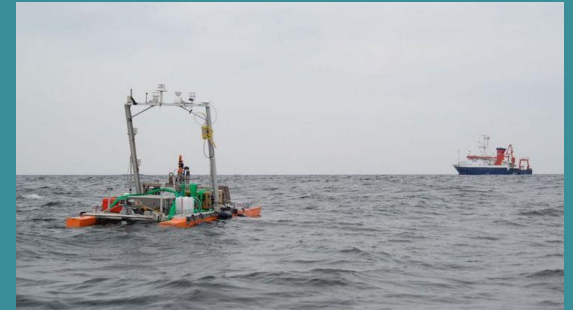
Der autonome Katamaran HALOBATES [Foto: L. Gassen]
