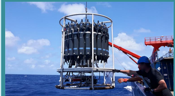
Wasserproben aus verschiedenen Tiefen des Nordatlantiks, gesammelt mit einer CTD-Rosette [Foto: M. Seidel]
