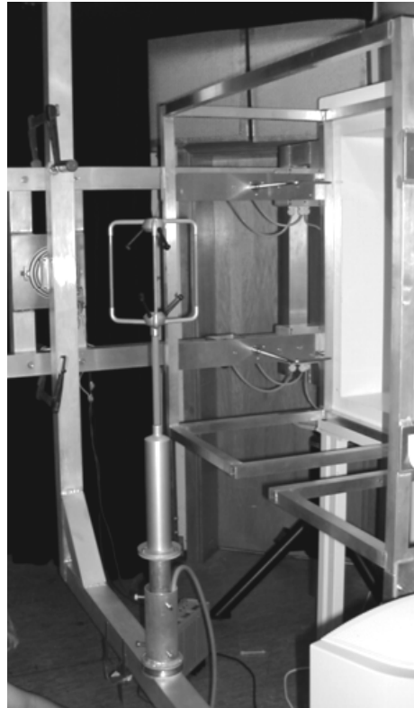
Abbildung 5: Messaufbau. Position des Anemometers auf dem Schwenkarm. Rechts daneben sind zwei der Staudruckrohre zu erkennen
