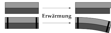
Abbildung 3.2: Funktionsweise eines Bimetalls . Der Wärmeausdehnungskoeffizient \alpha (siehe 3.3.6) ist in diesem Beispiel beim hellen Material größer.
