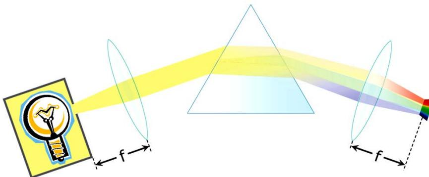
Schematischer Aufbau eines Prismenspektrometers, mit Lichtquelle und Spalt, Linse zur Parallelisierung des Lichtbündels, Prisma, und Linse zur spektral zerlegten Abbildung des Spalts in der Bildebene.
