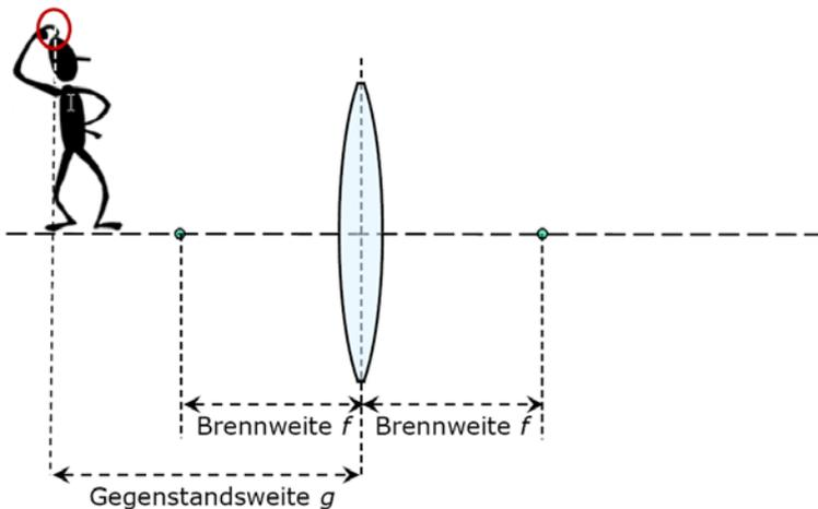
Zur Bestimmung der Brennweite von Linsen ist die Linsenformel ungeeignet, weil  $b$  und  $g$  auf die Linsenmitte ("Hauptebene") bezogen sind; diese ist jedoch – besonders bei Linsen in Fassungen – nicht lokalisierbar. Das *Besselsche Verfahren der Brennweitenbestimmung* geht davon aus, dass es für einen festen Abstand zwischen Gegenstand und Bild
