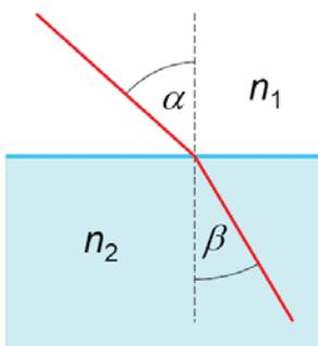
Beim Übergang aus einem durchsichtigen Stoff in einen anderen erfährt ein Lichtstrahl eine Richtungsänderung, die als Brechung bezeichnet wird. Es gilt das Gesetz von Snellius: Bilden der einfallende und der gebrochene Strahl mit dem Einfallslot den Einfallswinkel  $\alpha$  bzw. den Ausfallwinkel  $\beta$ , so gilt
