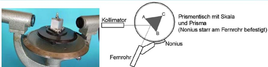
Im Experiment genutztes Prismenspektrometer.
