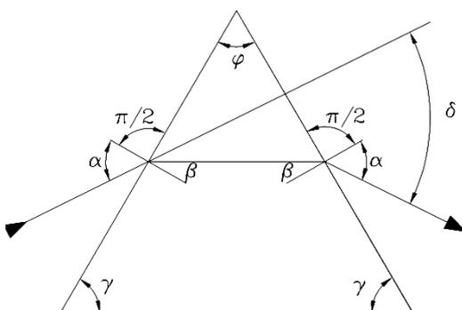
Durchsetzt ein Lichtstrahl ein Prisma, so wird er um den Ablenkwinkel  $\delta$  abgelenkt.  $\delta$  hängt von der Brechzahl des Prismenmaterials für die betreffende Wellenlänge, vom brechenden Winkel  $\varphi$  des Prismas und von der Lage des Prismas in Bezug zum einfallenden Lichtstrahl ab.  $\delta$  nimmt den kleinsten Wert an, wenn der Strahl symmetrisch durch das Prisma läuft; dies ist in der Abbildung links so angenommen.
