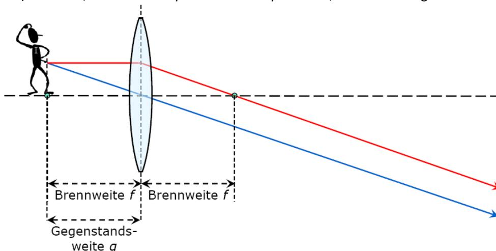
Diese Konstruktionsregeln gelten sowohl für die virtuelle als auch für die reelle Abbildung, vorausgesetzt, die Linse ist hinreichend dünn (Dicke  $\ll$  Durchmesser). Im Übrigen stellen diese drei Strahlen nicht tatsächlich existierende Lichtstrahlen dar; es handelt sich vielmehr um zeichnerische Mittel, die den Zusammenhang von Gegenstand und Bild richtig darstellen.
