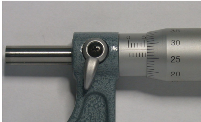
Abb. 1.7: Bügelmessschraube zeigt d = 5,78 \text{ mm}
