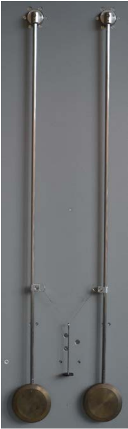
Abb. 6: Im Praktikum genutztes gekoppeltes Pendel. Die koppelnde Feder wird durch ein an beiden Pendeln befestigtes Gewicht realisiert.
