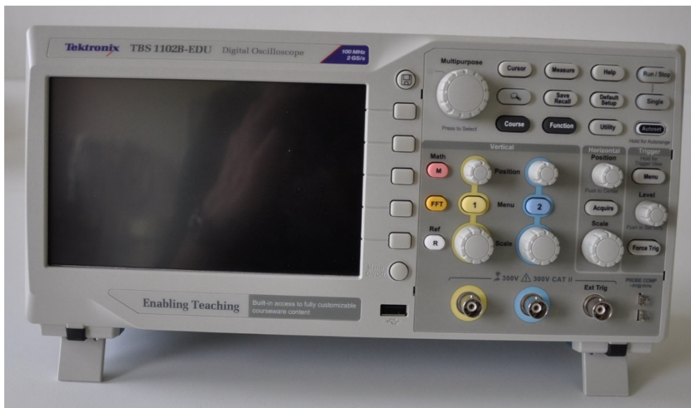
Abb. 11: Frontansicht des im Praktikum eingesetzten Digital-Oszilloskops TEKTRONIX TBS 1102EDU.
