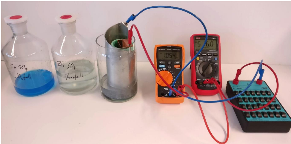
Abb. 4.1: Zur Messung des inneren Widerstandes einer Spannungsquelle.
