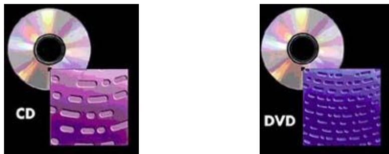
Abb. 13: Schematische Struktur der Spuren einer CD (links) und einer DVD (rechts) (Quelle: SONY).
