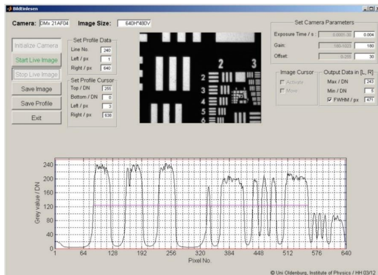
Abb. 15: Bildschirmoberfläche nach Start des Matlab-Skriptes BildEinlesen.m, Initialisierung der CCD-Kamera (Initialize Camera), Einstellung von Parametern (Set Camera Parameters, Set Profile Data, Set Profile Cursor) und Aufnahme eines Kamerabildes (Start Live Image, Stop Live Image). Das Kamerabild wird oben dargestellt, der zugehörige Profilschnitt unten. Grauwerte werden als „Digital numbers“ (DN) ausgegeben.
