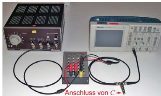
Abb. 13: Realer Aufbau der Schaltung aus Abb. 12. Links der Funktionsgenerator, rechts das Oszilloskop. In der Mitte die Widerstandsdekade mit dem Widerstand R_D . R_D liegt zwischen den beiden schwarzen Anschlussbuchsen der Widerstandsdekade. Die gelbe Buchse ist ein Stützkontakt ohne elektrische Verbindung zu R_D . In der Kabelverbindung zwischen Oszilloskop und Widerstandsdekade befindet sich ein BNC-T-Stück, an das der Kondensator mit der zu messenden Kapazität C angeschlossen wird.
