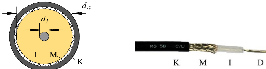
Abb. 5: Koaxialkabel. Links : Querschnitt, rechts : Seitenansicht. K: Kunststoffmantel, M: äußerer Metallmantel (Drahtgeflecht) mit Durchmesser d_a , I: Isolationsmaterial, D: Innenleiter mit Durchmesser d_i (Draht oder Litze).
