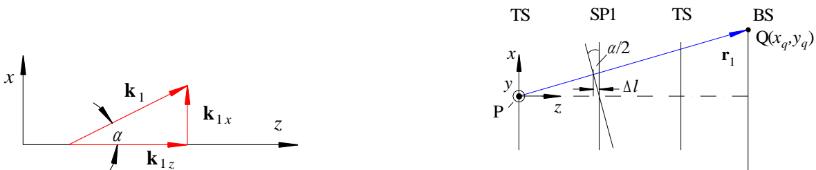
Abb. 5: Links: Wellenvektor \mathbf{k}_1 bei Verkipfung der Ausbreitungsrichtung der Welle E_1 um den Winkel \alpha gegenüber der z -Achse. Rechts: Ortsvektor \mathbf{r}_1 bei Verkipfung des Spiegels SP1 um den Winkel \alpha/2 um die y -Achse.
