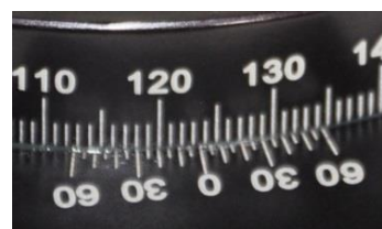
Abb. 8: Links: Polarisationsfilter ( P_2 ) in feinverstellbarer Drehhalterung. Rechts: vergrößerter Ausschnitt der Skala, auf der ein Winkel von 123^\circ 30' angezeigt wird.
