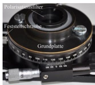
Abb. 8: Links: Polarisationsfilter ( P_2 ) in feinverstellbarer Drehhalterung. Rechts: vergrößerter Ausschnitt der Skala, auf der ein Winkel von 123^\circ 30' angezeigt wird.
