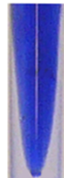
Abb. 11: Links: Berechnetes parabolisches Geschwindigkeitsprofil einer laminaren Strömung durch ein zylindrisches Rohr mit dem Radius r_0 . Rechts: Visualisierung eines parabolischen Geschwindigkeitsprofils in einem zylindrischen Plexiglasrohr (Durchmesser ca. 1 cm) mit Hilfe von eingefärbtem Kleister. 15
