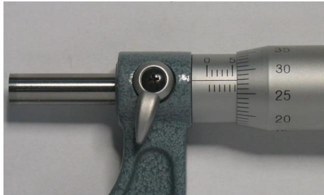
Bügelmessschraube zeigt  $d = 5,78 \text{ mm}$
