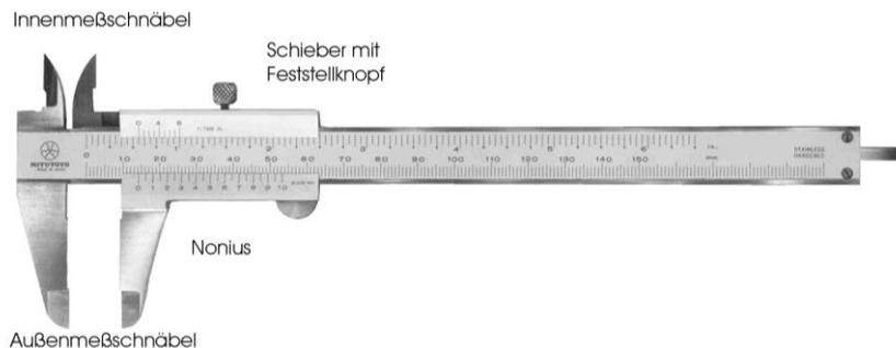
Ein Messschieber zur Bestimmung von Längen. Welche Fehler können auftreten?
