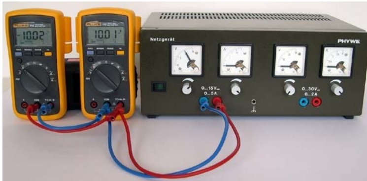
Abb. 2: Zum Vorzeichen der Spannung aus einem Netzgerät. An dessen linkem Ausgang ist eine Spannung von ca. 10 V eingestellt. Das linke Multimeter (Typ FLUKE) zeigt eine Spannung von -10,02 \text{ V} an, das rechte eine Spannung von +10,01 \text{ V} 4 . Ursache: der Bezugspunkt für die Spannungsmessung (schwarze Buchse COM am Multimeter) ist links mit der roten Buchse des Netzgerätes verbunden (an der das höhere Potential liegt), rechts mit der blauen Buchse (an der das niedrigere Potential liegt).
