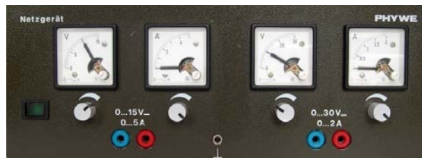
Abb. 1: Netzgerät vom Typ PHYWE. An beiden Ausgängen (jeweils blaue und rote Buchse) ist eine Spannung von ca. 10 V eingestellt.
