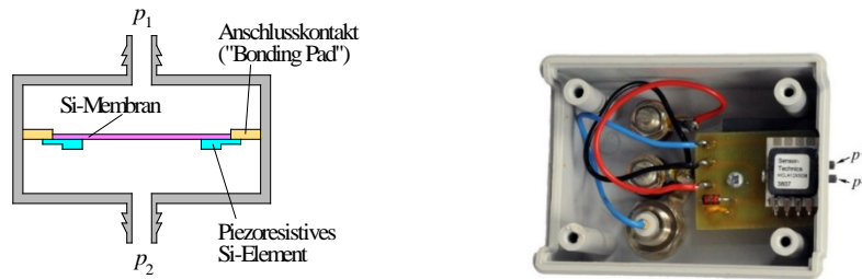
Abb. 3: Links: Schematische Darstellung eines piezoresistiven Drucksensors zur Messung eines Differenzdruckes \Delta p = p_2 - p_1 . Rechts: Blick in das Gehäuse des im Basispraktikum eingesetzten Drucksensors. Innen rechts befindet sich auf einer kleinen Platine der in einen IC integrierte Sensor. Rechts außen sind die Schlauchanschlüsse zu erkennen ( p_1 = p^- , p_2 = p^+ ).
