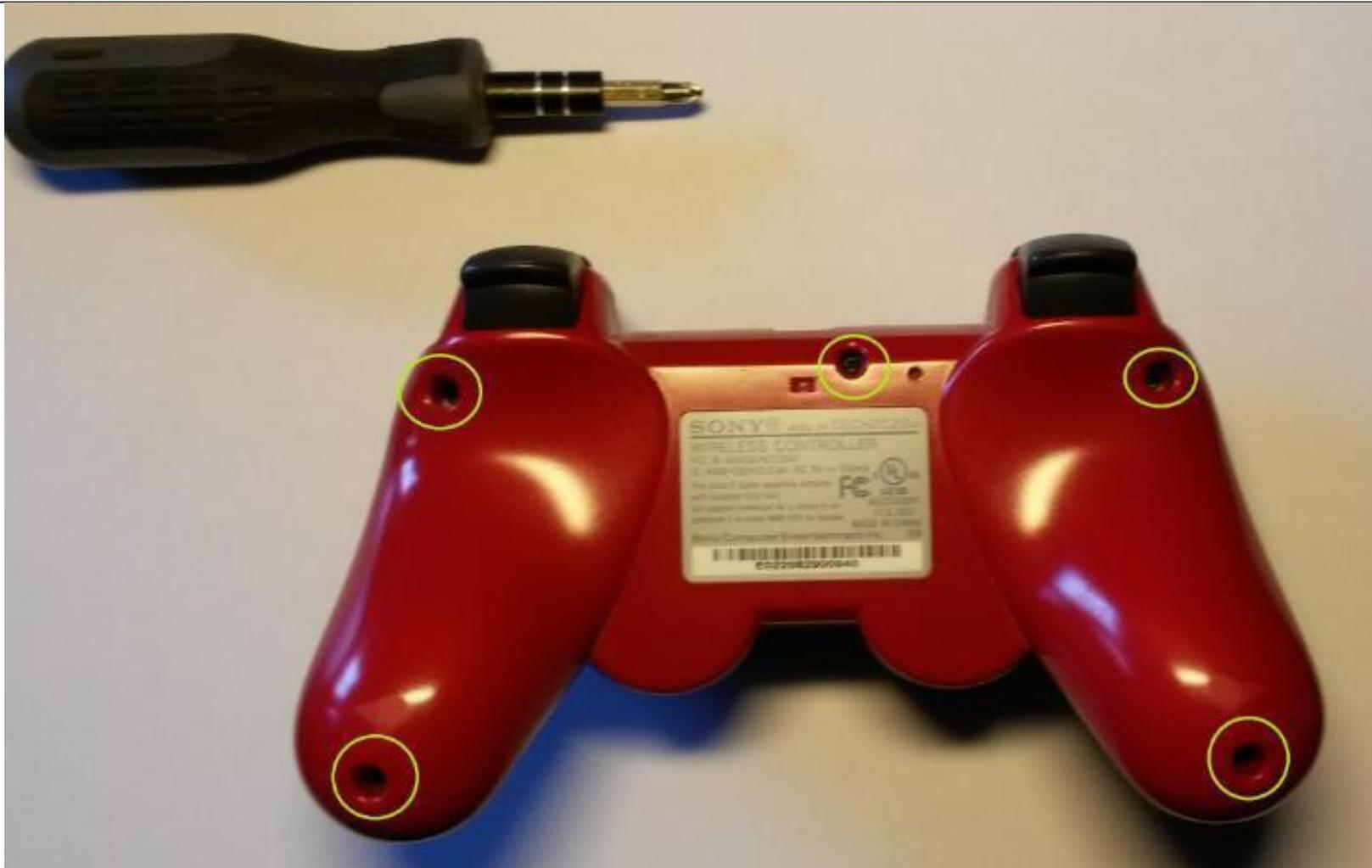
Löse die markierten Schrauben und drehe sie vollständig raus.
