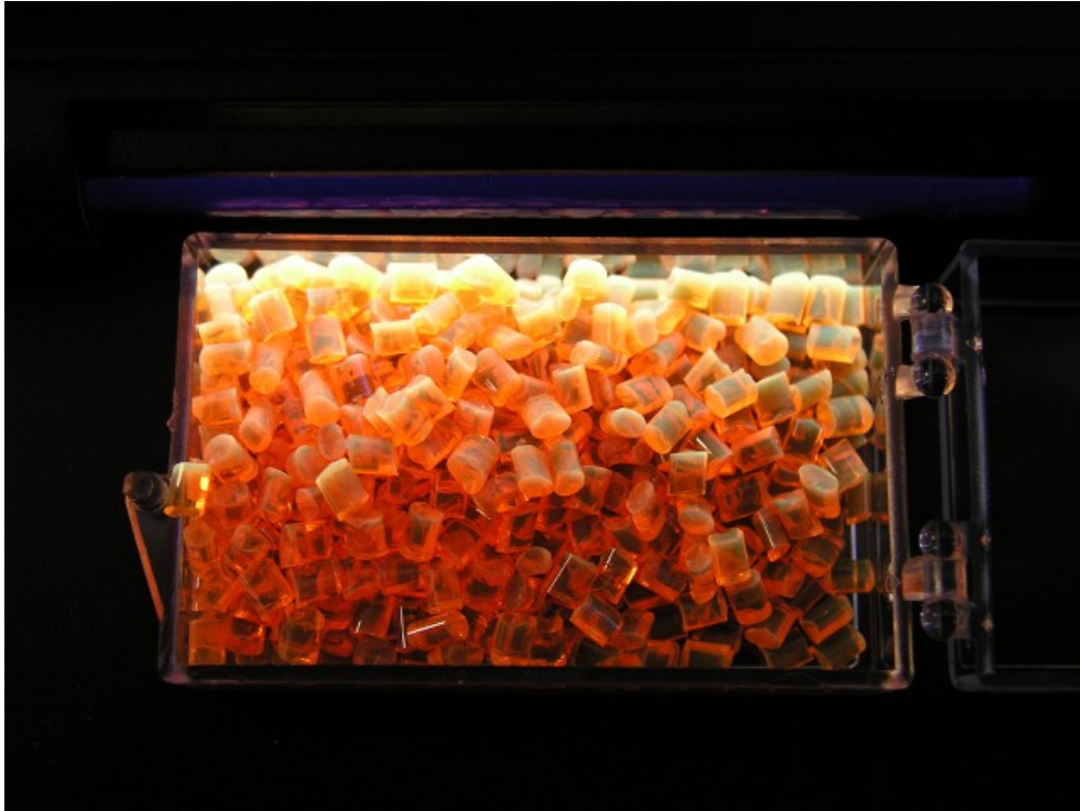
Abb. 2: Oranges Granulat leuchtet unter UV-Licht in einem hellen Gelb.
