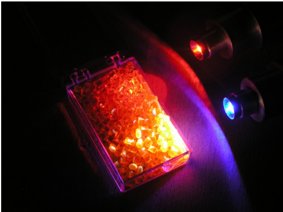
Abb. 3: Fluoreszierendes Granulat bei Beleuchtung mit einer blauen und einer roten LED. Das Licht kürzerer Wellenlänge regt das (helle) gelbe Leuchten, die Fluoreszenz an.
