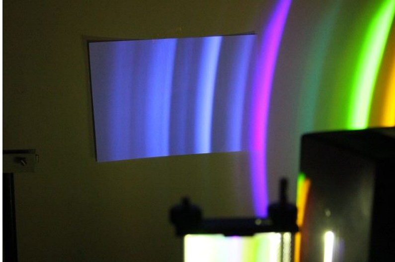
Abb. 10: Spektrum einer Quecksilberdampf Lampe ohne Glaskolben.
