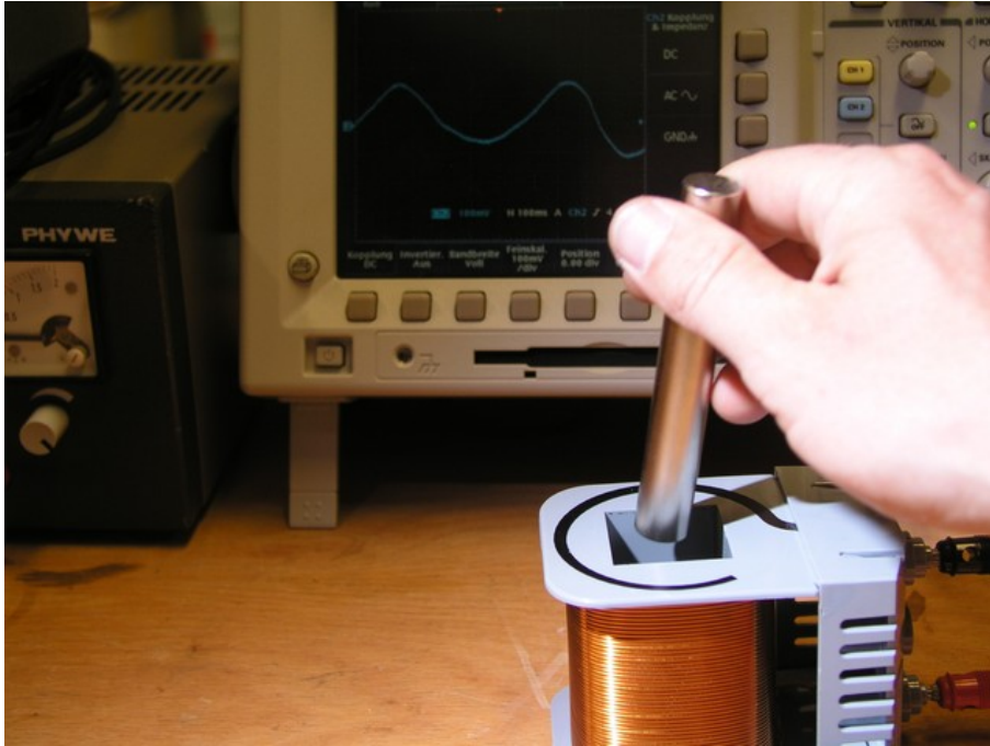
Abb. 2: Ein Stabmagnet wird in einer Spule bewegt und induziert Spannung.
