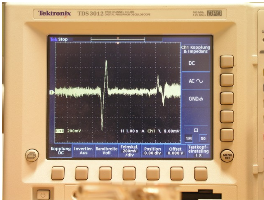
Abb. 1: Induzierte Spannungen wenn ein kleiner Stabmagnet erst schnell und danach langsam durch eine Spule fällt.
