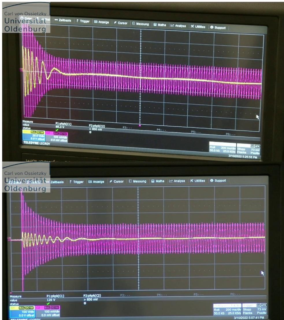
Abb. 5: Stromverlauf in Stator und Rotor bei  $4,7\Omega$  (oben) und  $10\Omega$  (unten). Die Skalierung für den Statorstrom (lila) ist bei beiden Bildern die Gleiche. Der Anlaufstrom ist oben größer. Die Zeitauflösung ist jeweils die gleiche, im unteren Bild ist der langsamere Anlauf und ein geringerer Anlaufstrom deutlich zu erkennen.
