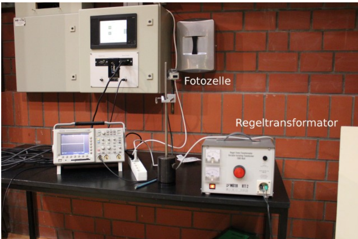
Abb. 4: Messung der Umlaufzeit des Spiegels und Geschwindigkeitssteller
