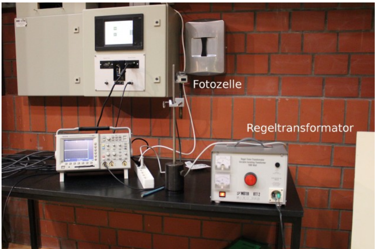
Abb. 4: Messung der Umlaufzeit des Spiegels und Geschwindigkeitssteller
