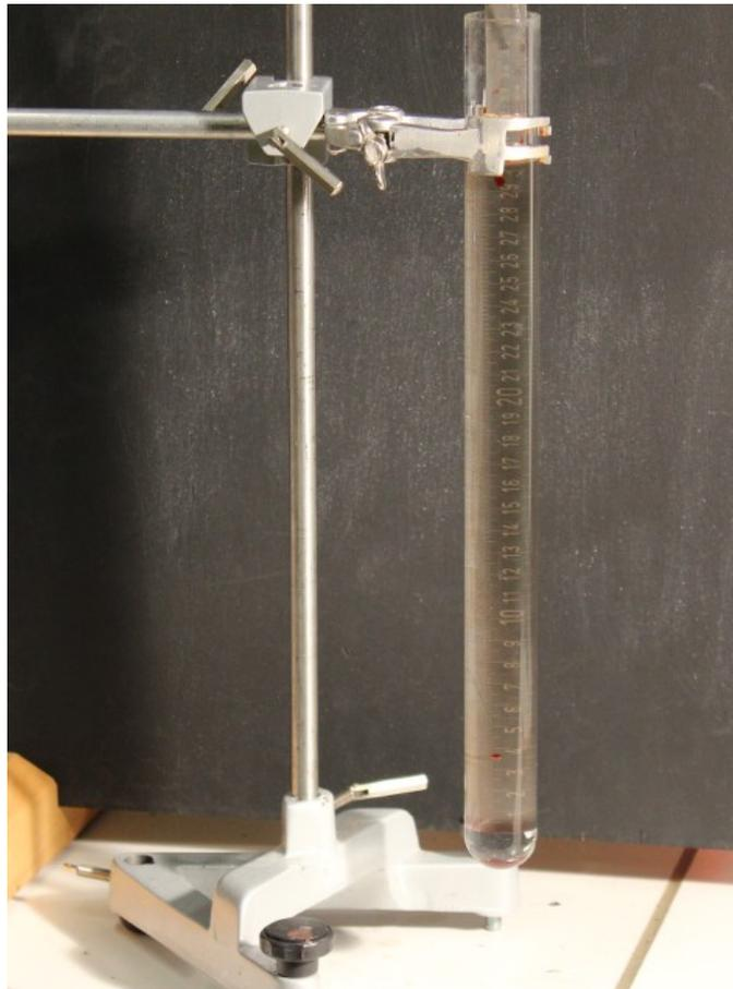
Abb. 2: Anordnung zur Überprüfung der Stokesschen Reibung
