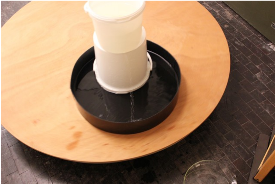
Abb. 1: Ausfließendes Wasser auf einer Drehscheibe
