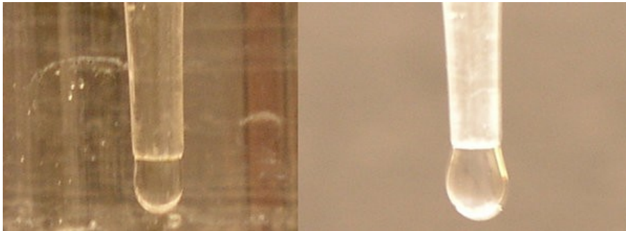
Abb. 3: Tropfen in Ether (links) und in Luftatmosphäre.
