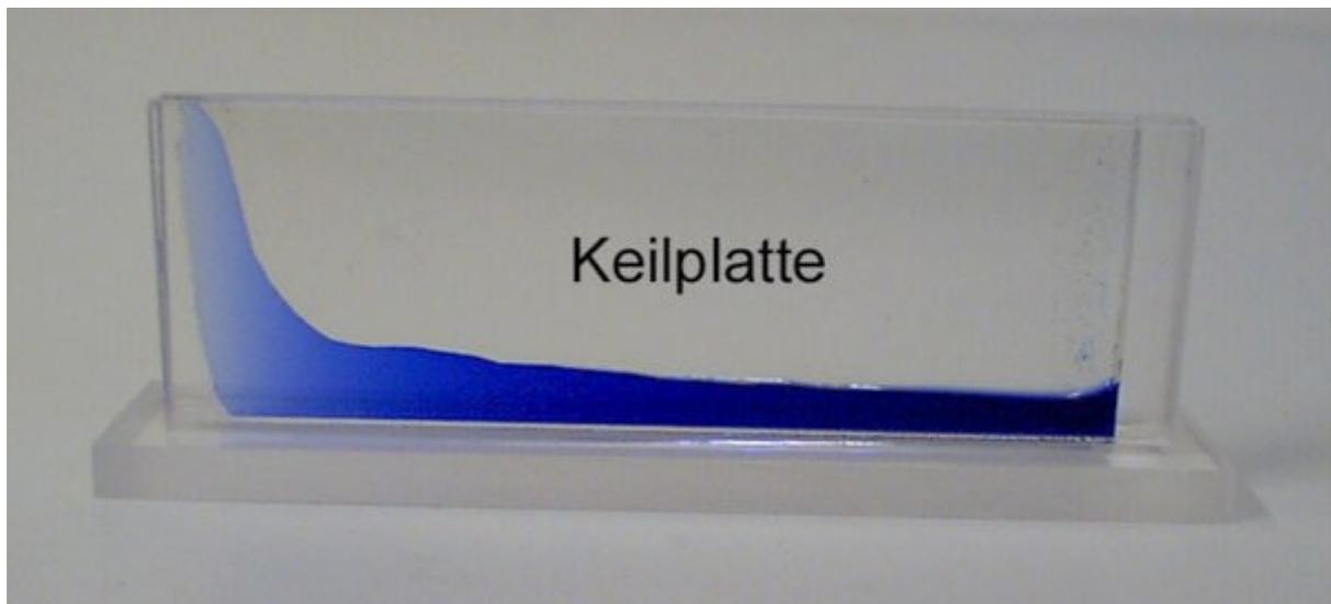
Abb. 1: Kapillarkräfte lassen einen Flüssigkeitsfilm zwischen 2 Platten steigen.
