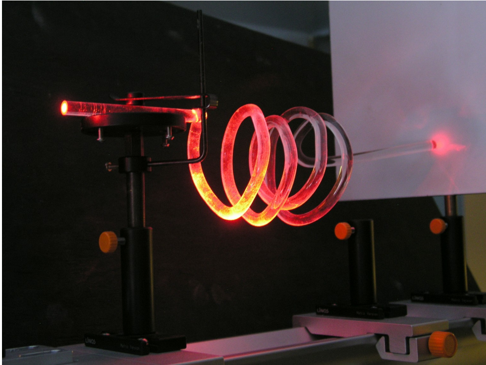
Abb. 2: Bei zu starker Biegung ist der Winkel zur Totalreflexion überschritten und ein Teil des Lichtes kann aus der Faser austreten.
