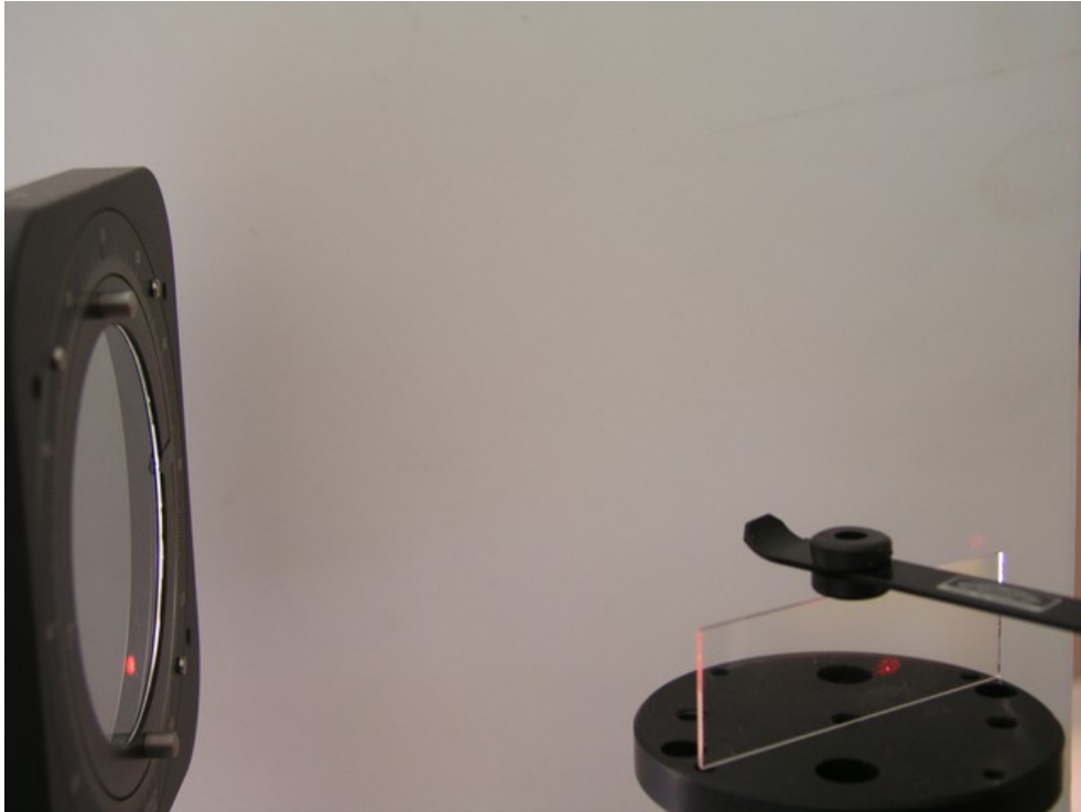
Abb. 4: Der Objektträger kann auf der Halterung um die senkrechte Achse gedreht werden.
